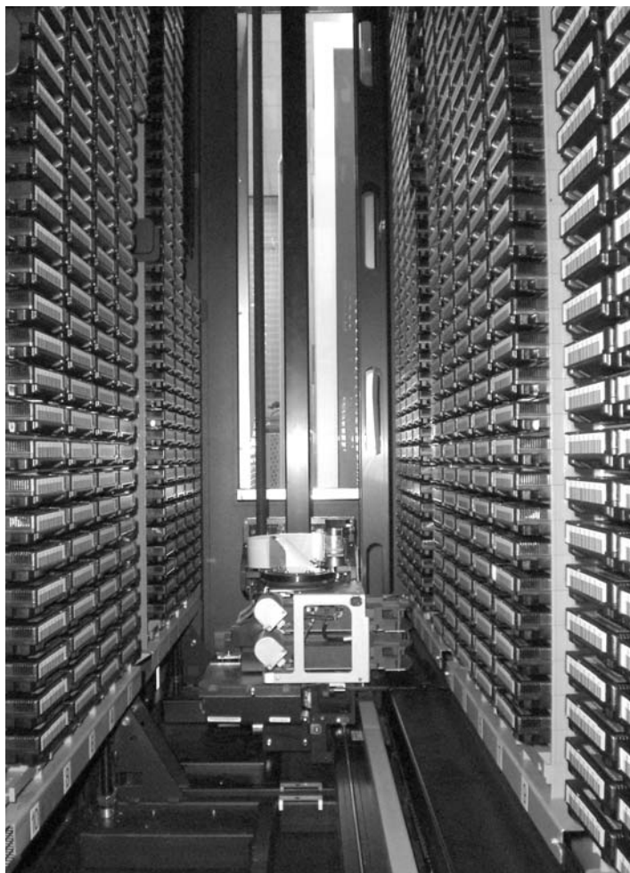
Abb. 2: Blick in das Innere des Bandroboters des neuen Backup-Systems
