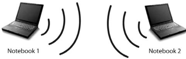
Abb. 2: Beispiel für den Betrieb eines WLAN im Ad-Hoc-Modus
